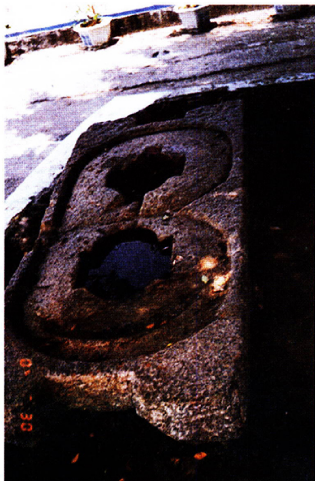
高雄縣橋頭鄉新莊義山宮大樹下之古代壓榨 甘蔗用軋輥之支撐座及收集蔗汁之溝槽
