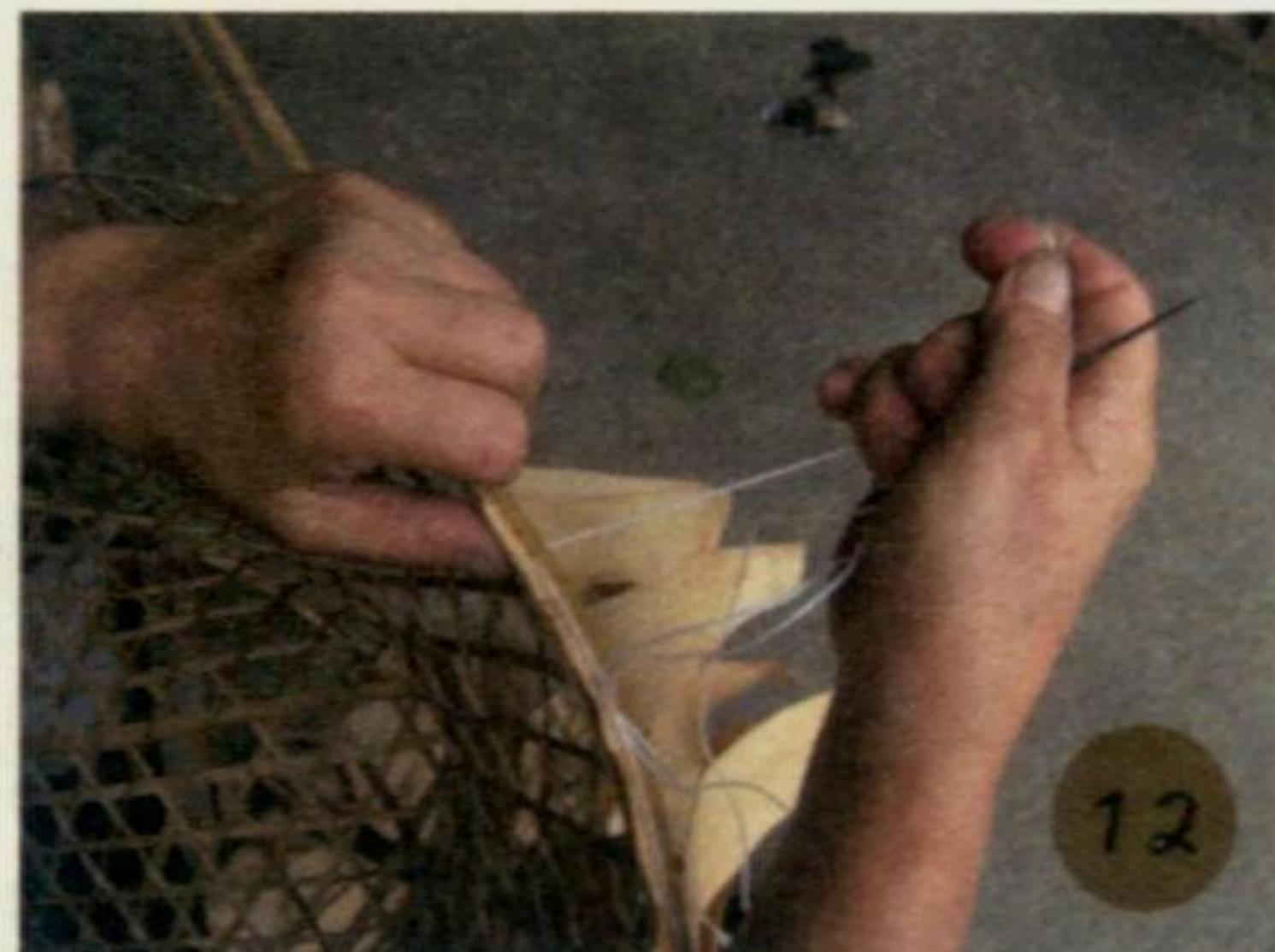
在編好的笠胎外緣（圖12）。外人看似簡單的縫合動作，實需相當的技巧，有時甚至需要以牙齒咬合，以幫助竹籜、笠胎及內外甲的密合；且勒緊尼龍繩時須相當的指端力道，冬天天冷手指常因使力及尼龍繩的磨擦而龜裂受傷、甚至流血。員林、竹
