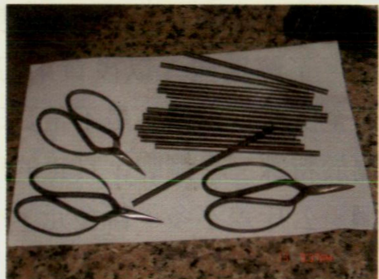
圖2：鋼條與打造完成的繡剪
