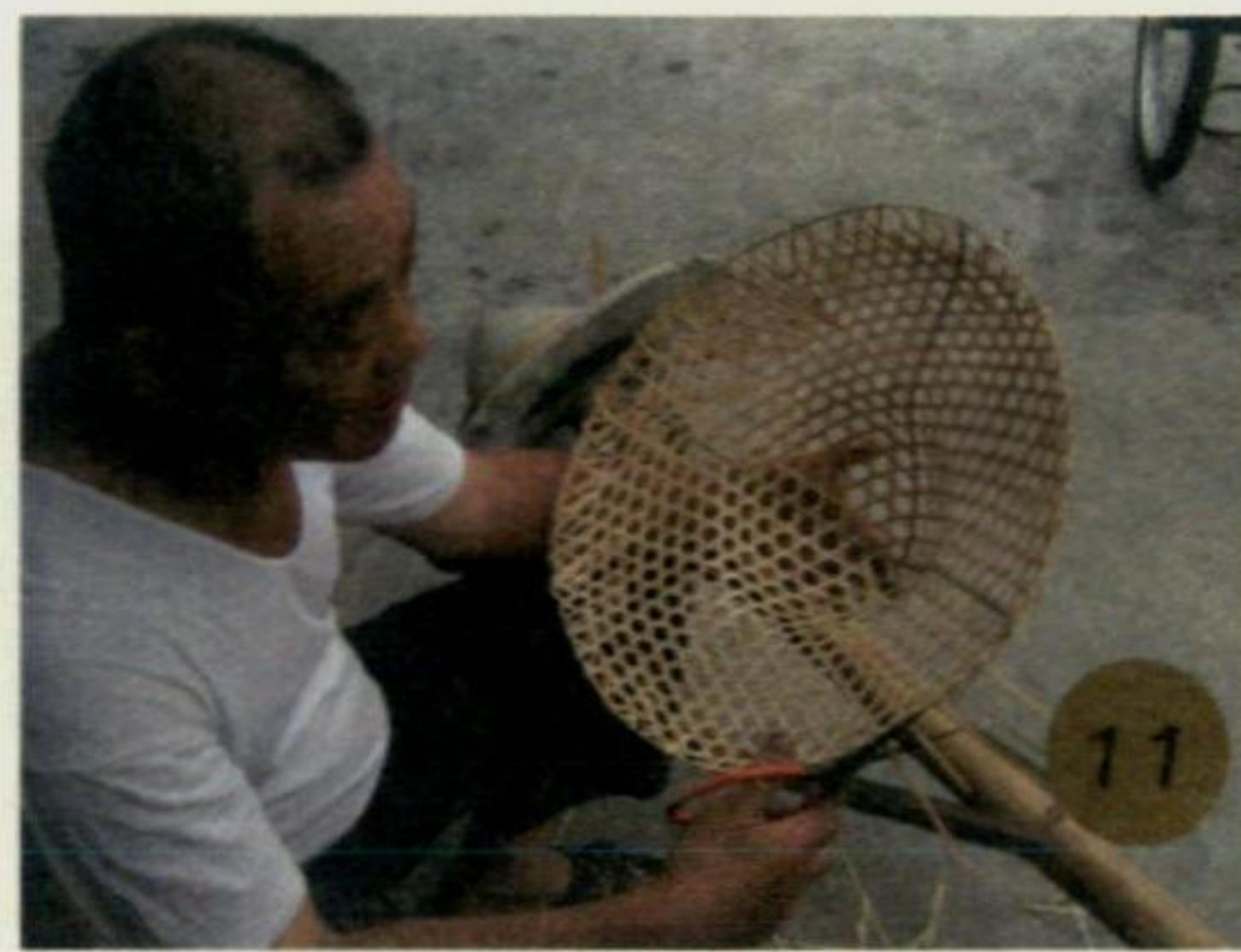
3、修笠胎墘：將煞笠邊後過長、突出的竹篾加以修整，以免傷到載者的額頭。（圖11）
