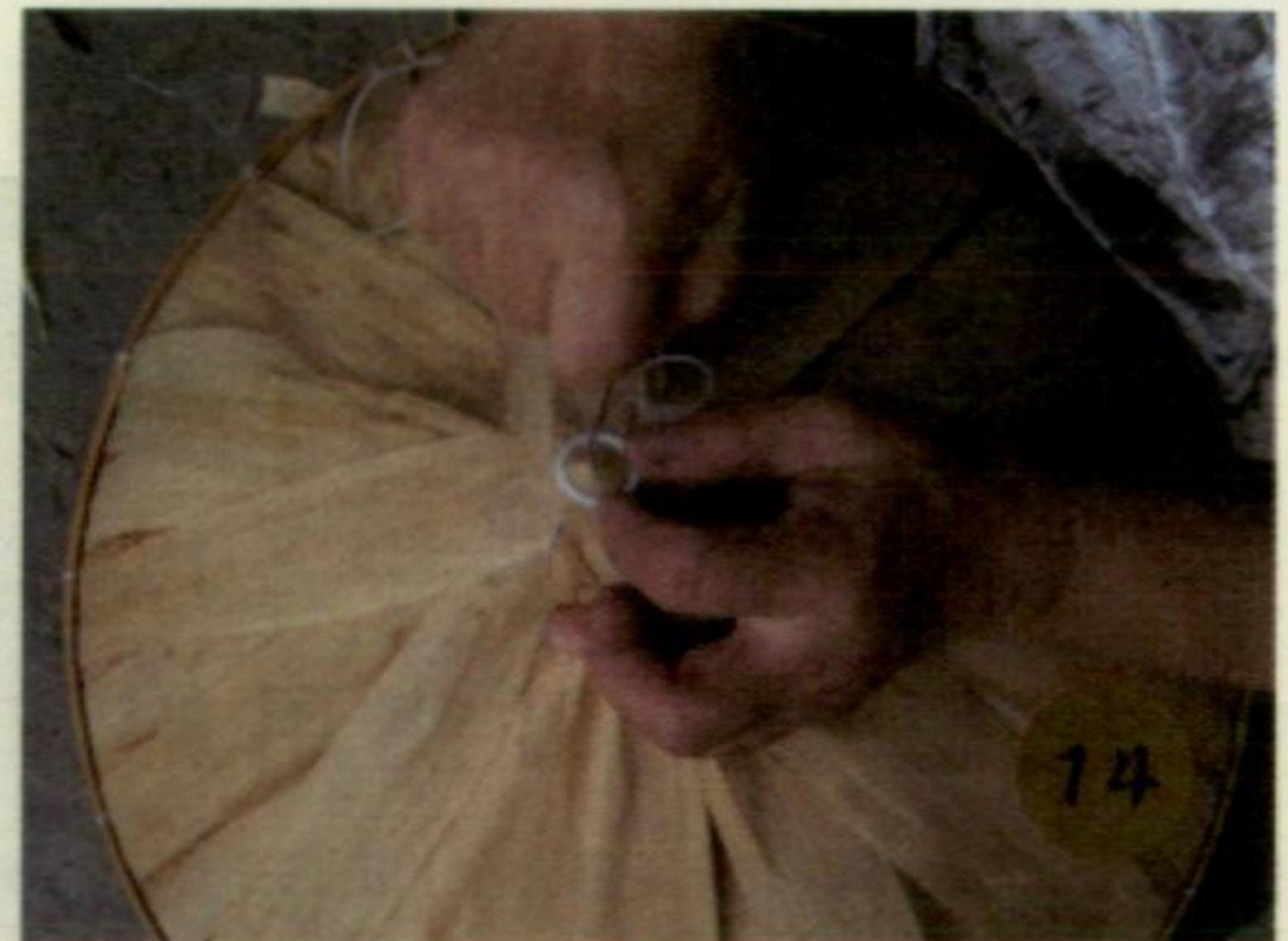
7、壓竹籜使成型：縫上去的竹籜需以水泥做成中空的模型壓過
