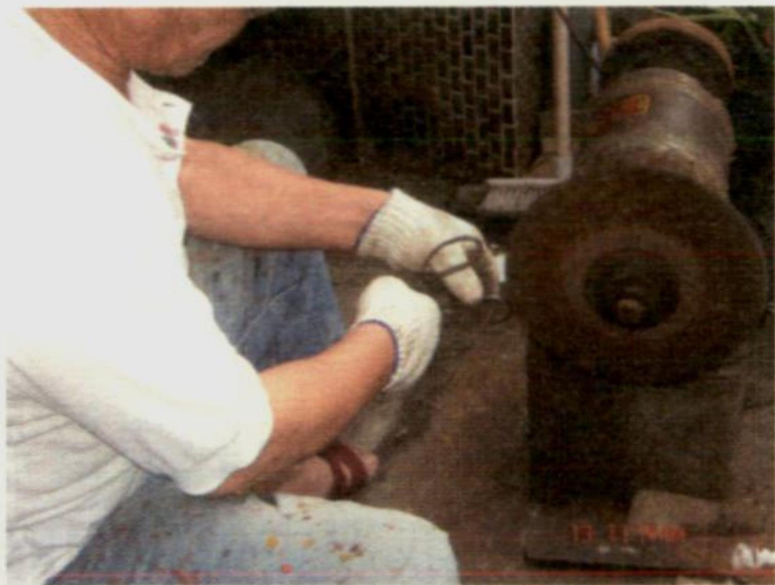
圖16：以機器取代人力磨刀柄的工作
