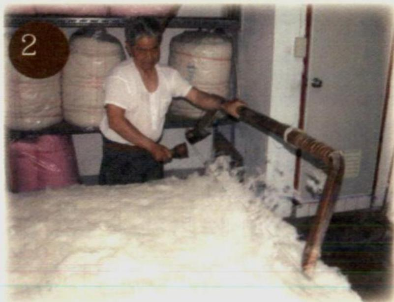
3、彈棉：即腰背繫一支長竿子，頂端一條垂線綁在棉弓上，左手扶弓、右手持弓槌擊打弓弦（牛筋材質），棉花在弓弦上下彈動下漸漸蓬鬆、均勻，而棉絮間更緊密結合形成勾釘的效果。（如圖2、3）
