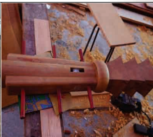
圖 4-22 前、中、後桅安裝滑輪
