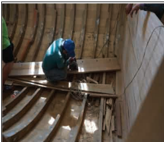
圖 4-13 船艙內開始施作水密隔艙
