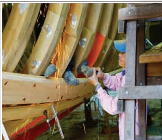
圖 4-12 螺絲過長部份需磨平
