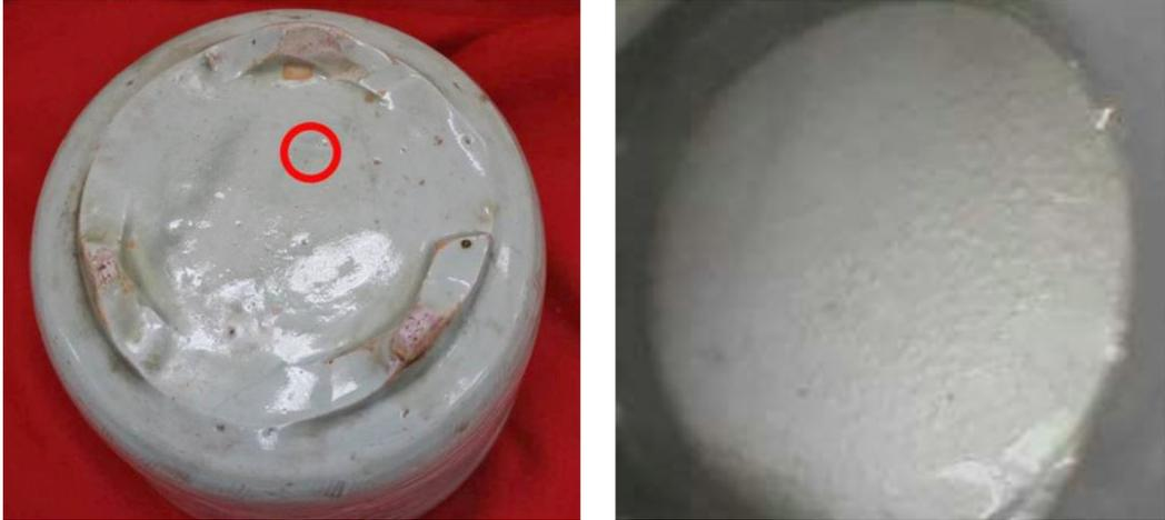
圖 91 花蓮延平王廟東溪窯纏枝牡丹紋筒式青瓷爐爐底釉層 XRF 胎檢測點，測點編號 324、325 測點 / 採樣部位爐外側底部釉，分析模式礦物，土壤模式
