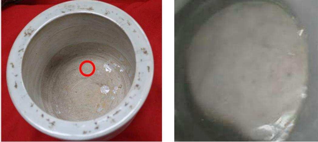
圖 89 花蓮延平王廟東溪窯纏枝牡丹紋筒式青瓷爐內無胎處 XRF 檢測點，測點編號 324、325 測點 / 採樣部位爐內側底部無釉處分析模式礦物，土壤模式
